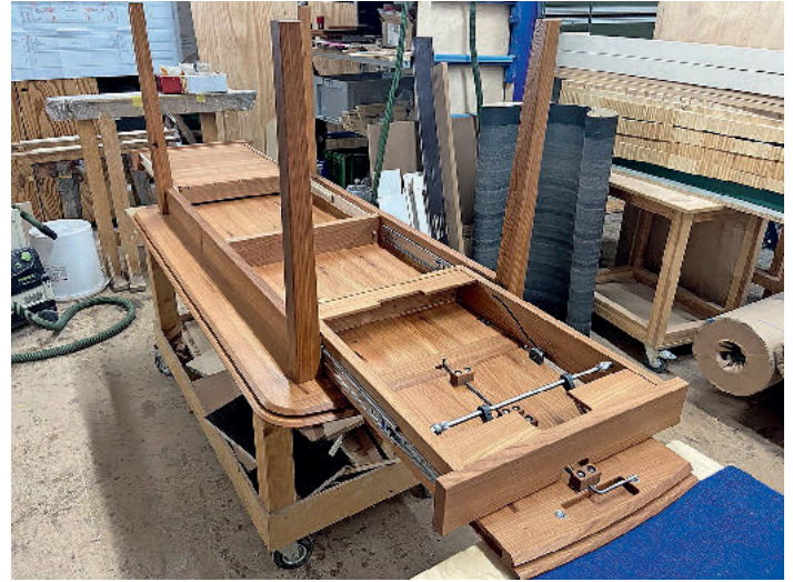
/ Durchdachte Technik: In fertig montiertem Zustand werden die Funktionen des vom Meisterschüler selbst entwickelten Auszuges noch einmal erkennbar.
