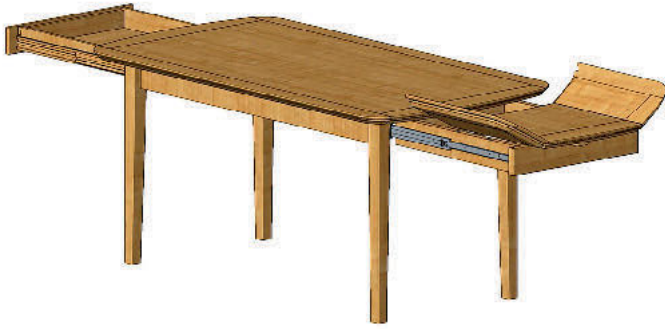
/ Räumliche Darstellung: Die farbig angelegte Perspektive des Esstisches zeigt die beidseitigen Auszüge in Form eines Schubkastens und einer Tischverlängerung.
